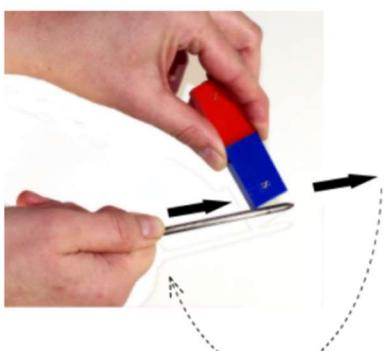
Uzmemo li željezni čavao/ekser i po njemu stružemo magnet uvijek u istom smjeru (30-50 puta), čavao/ekser će se magnetizirati.
